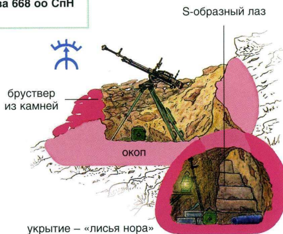
7,62-мм пулемет «57» с ракурсным прицелом на треножном станке в положении для стрельбы по воздушным целям.
