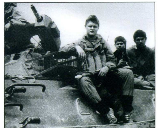
БТР-70Г 3 роты 154 оо СпН. Бронетранспортер БТР-70Г, кроме спаренных пулеметов КПВТ и ПКТ, был вооружен и сокурсным с ними 30-мм автоматическим гранатометом АГ-17 (боекомплект 195 выстрелов ВОГ-17). Санинструктор отряда рядовой Игорь Стокич. Джелалабад, 1986 г.
