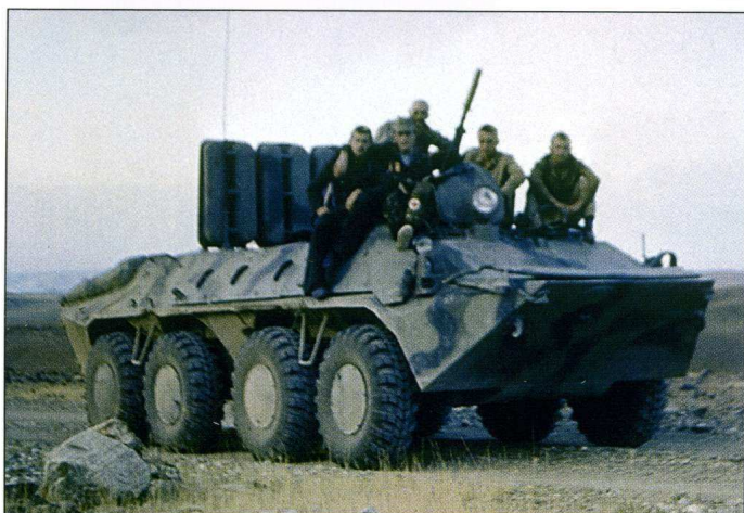
Бронетранспортер с дополнительным бронированием бортов БТР-70Д. 154 оо СпН, провинция Нангархар, 1987 г.
