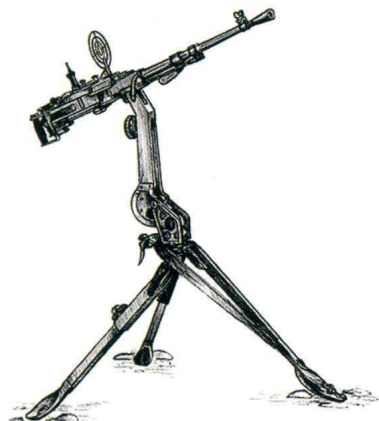
7,62-мм пулемет «57» с ракурсным прицелом на треножном станке в положении для стрельбы по воздушным целям.
